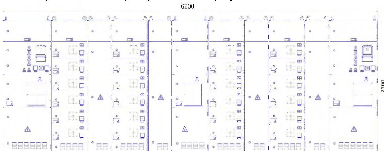
Рисунок 6.4 – Вариант с двумя линейными шкафами силовых сборок в каждой секции
