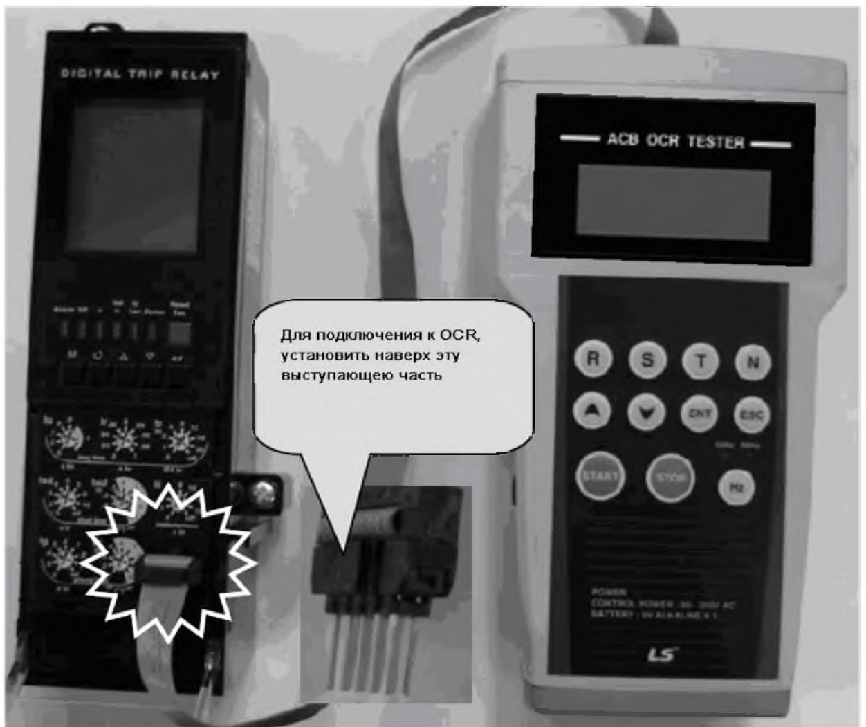
Рисунок 70 - Подключение OCR к аккумулятору
