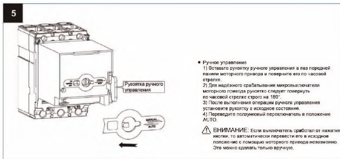
Рисунок 66. Ручное управление выключателем с помощью моторного привода
