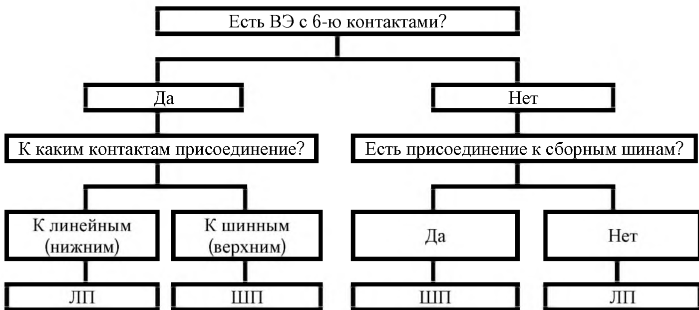
Рисунок 2 – Определение вида присоединения (в скобках указано для КРУ с верхним расположением сборных шин СЭЩ-70)
