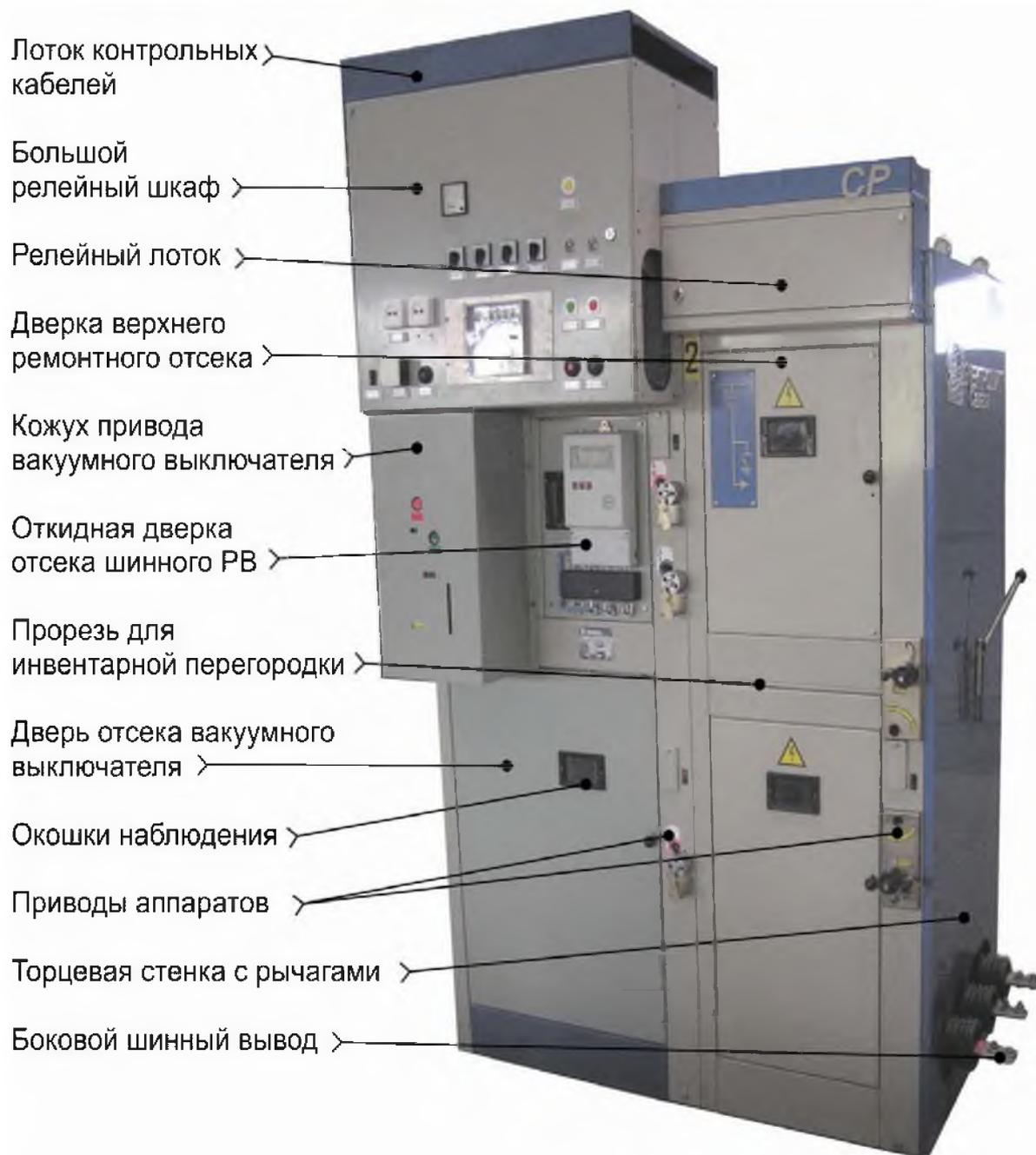
Рисунок 1а - Камеры с вакуумным выключателем и с разъединителем (камеры условно поставлены рядом, с разными релейными шкафами)
