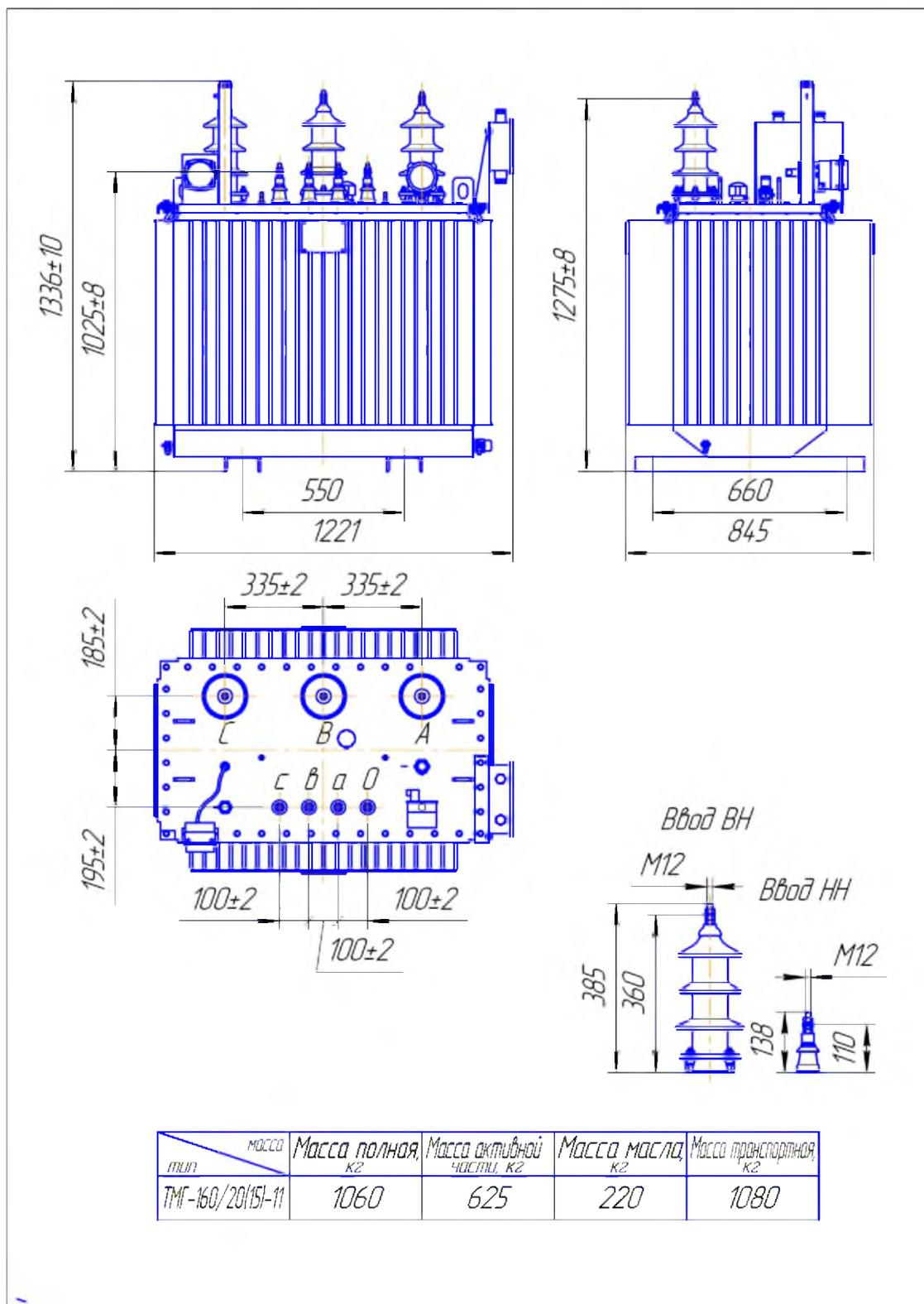
Рис. 2.2 Габаритные, установочные и присоединительные размеры трансформатора ТМГ - 160/20-11
