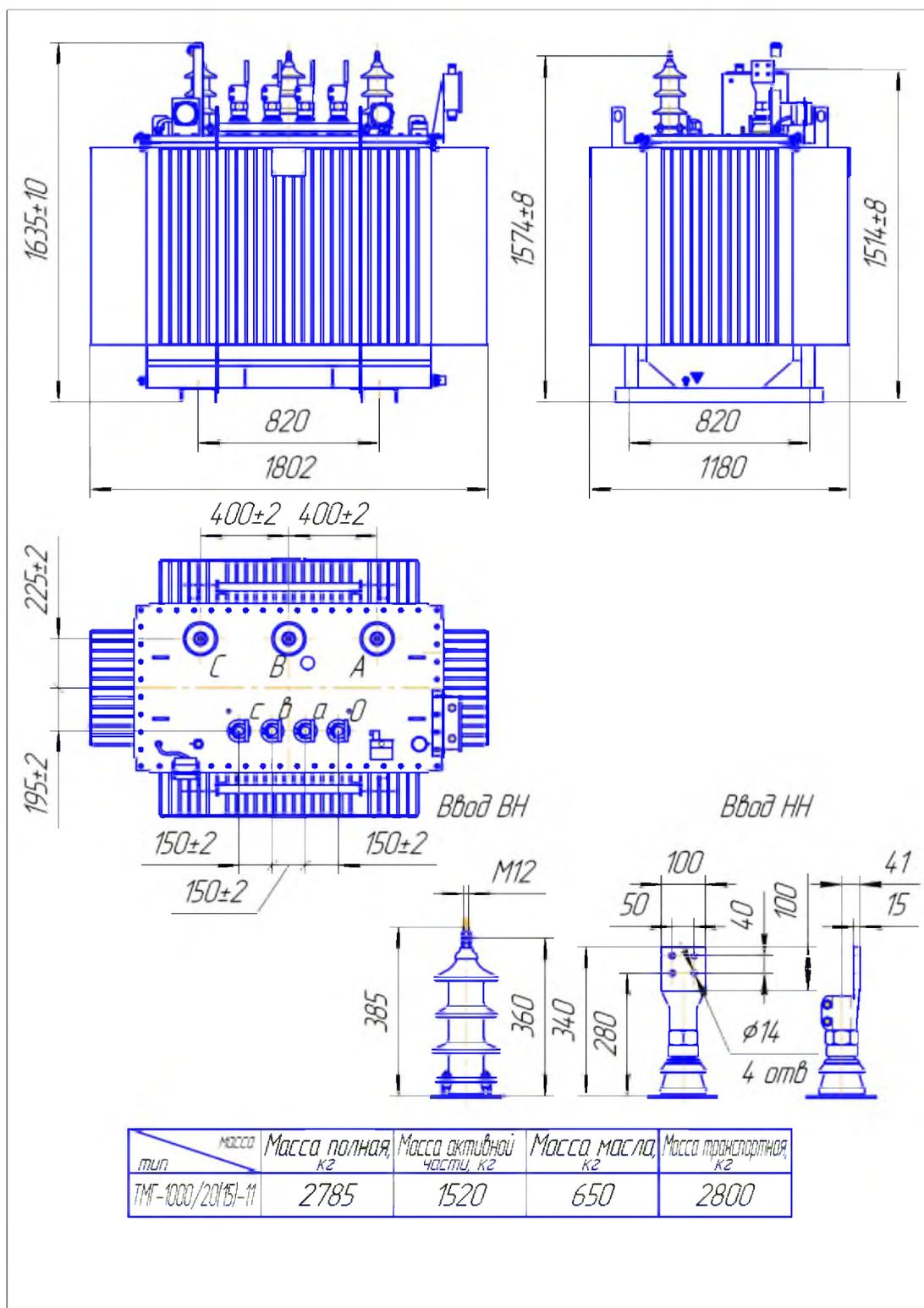
Рис. 2.6 Габаритные, установочные и присоединительные размеры трансформатора ТМГ - 1000/20-11
