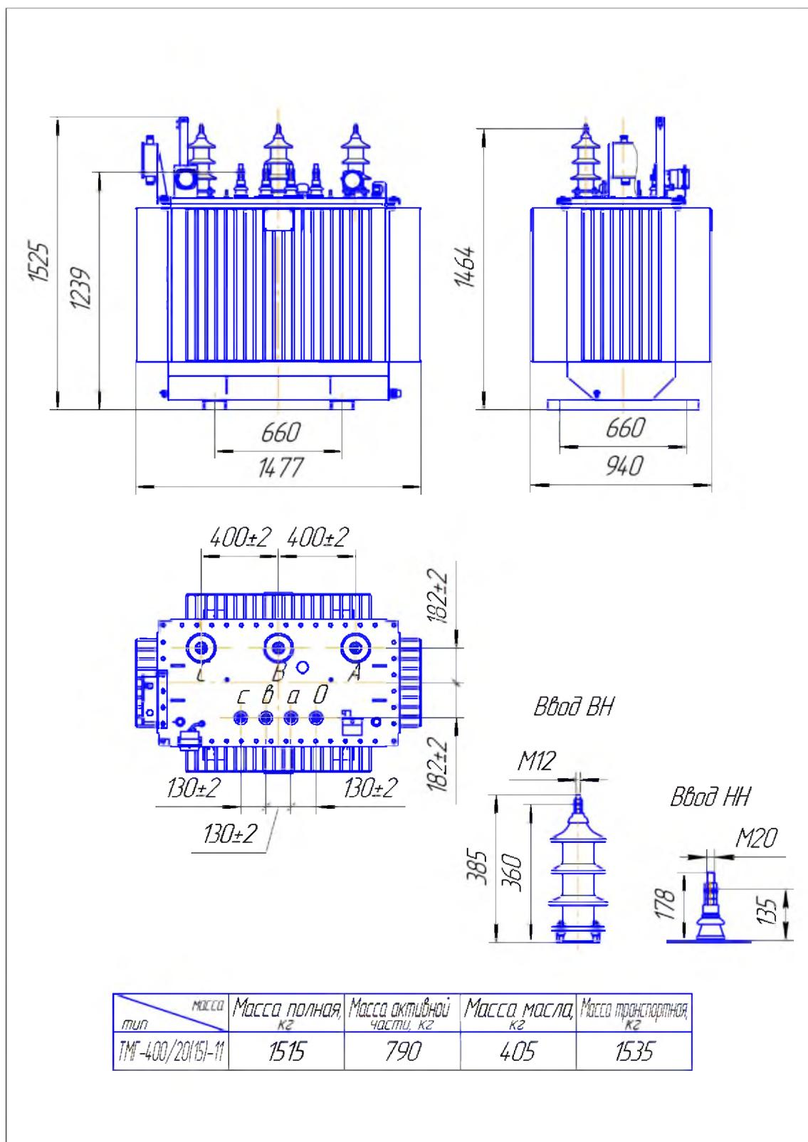
Рис. 2.4 Габаритные, установочные и присоединительные размеры трансформатора ТМГ - 400/20-11
