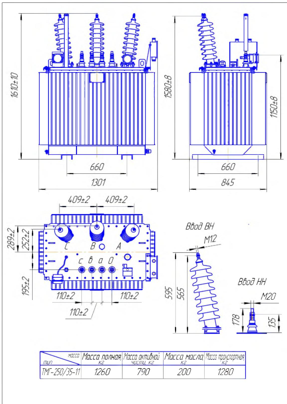
Рис. 3.3 Габаритные, установочные и присоединительные размеры трансформатора ТМГ - 250/35-11
