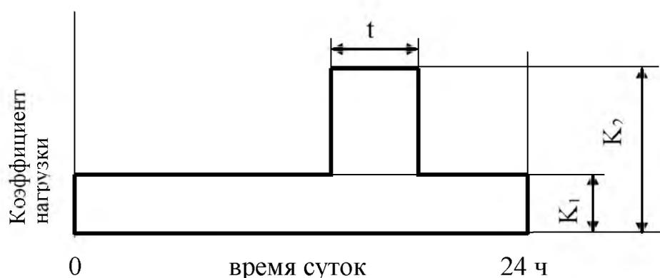
Рис. 5.1 Эквивалентный двухступенчатый график нагрузки
