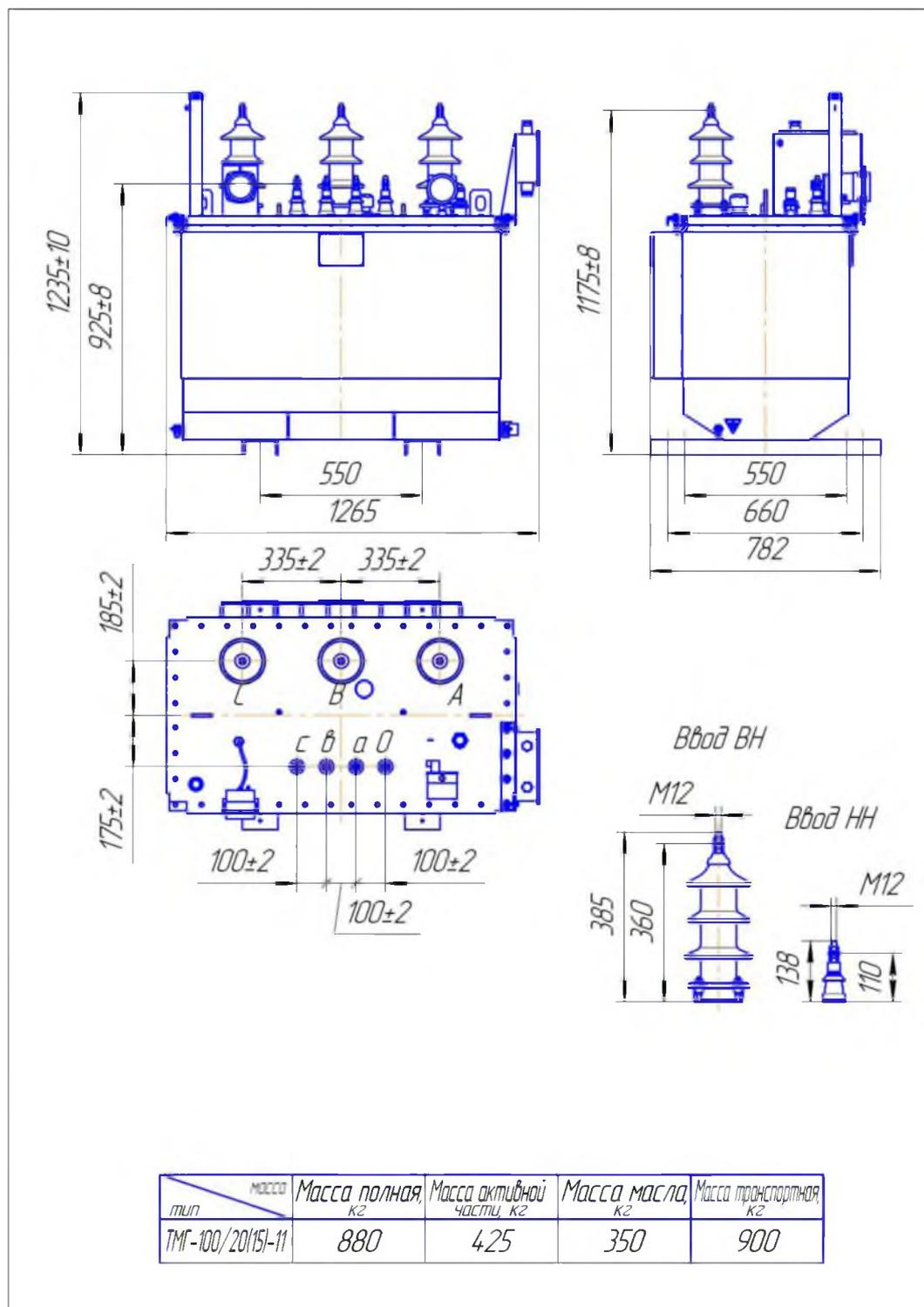
Рис. 2.1 Габаритные, установочные и присоединительные размеры трансформатора ТМГ - 100/20-11
