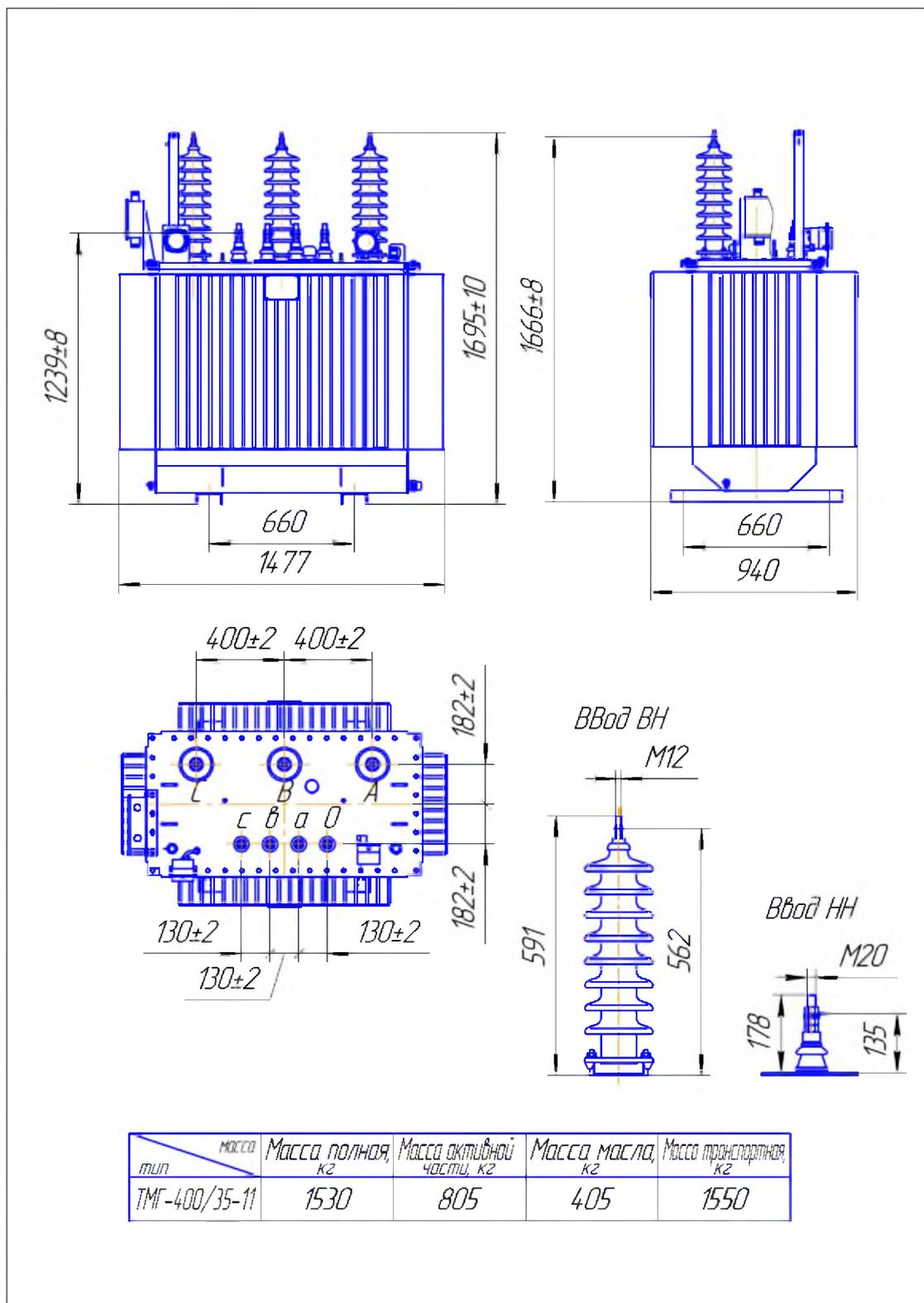
Рис. 3.4 Габаритные, установочные и присоединительные размеры трансформатора ТМГ - 400/35-11
