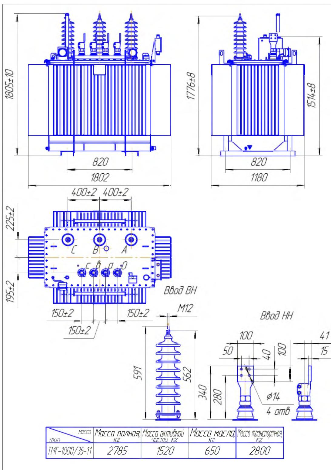
Рис. 3.6 Габаритные, установочные и присоединительные размеры трансформатора ТМГ - 1000/35-11
