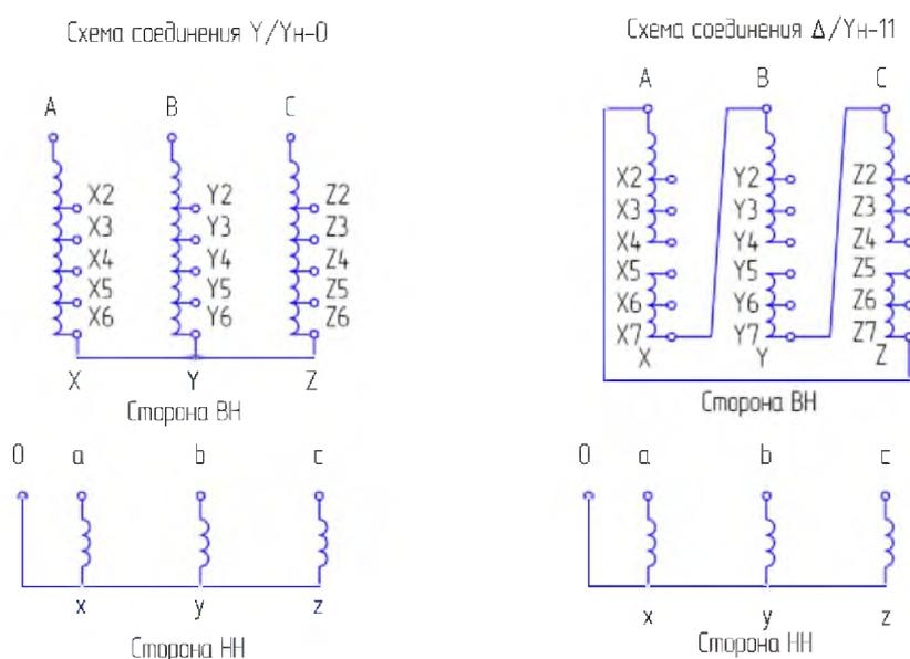
Рис. 4.1 Основные применяемые схемы и группы соединения обмоток
