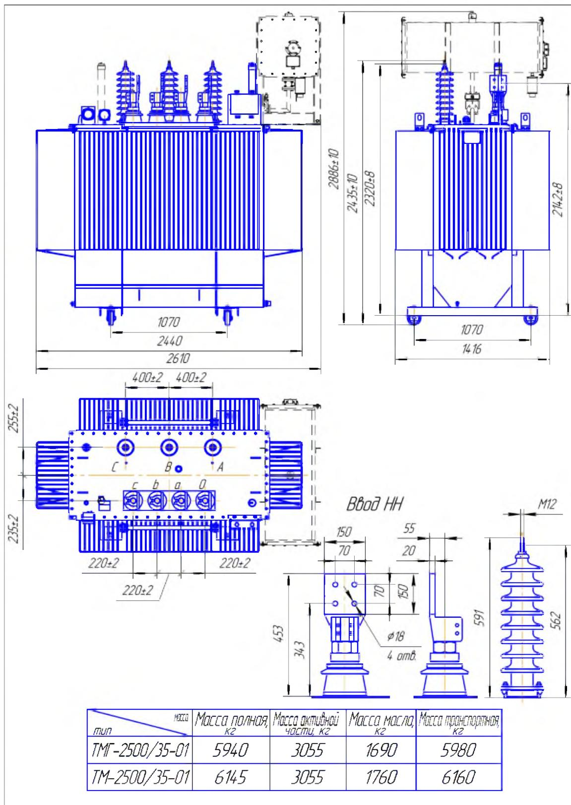
Рис. 3.9 Габаритные, установочные и присоединительные размеры трансформатора ТМ(Г) - 2500/35-01
