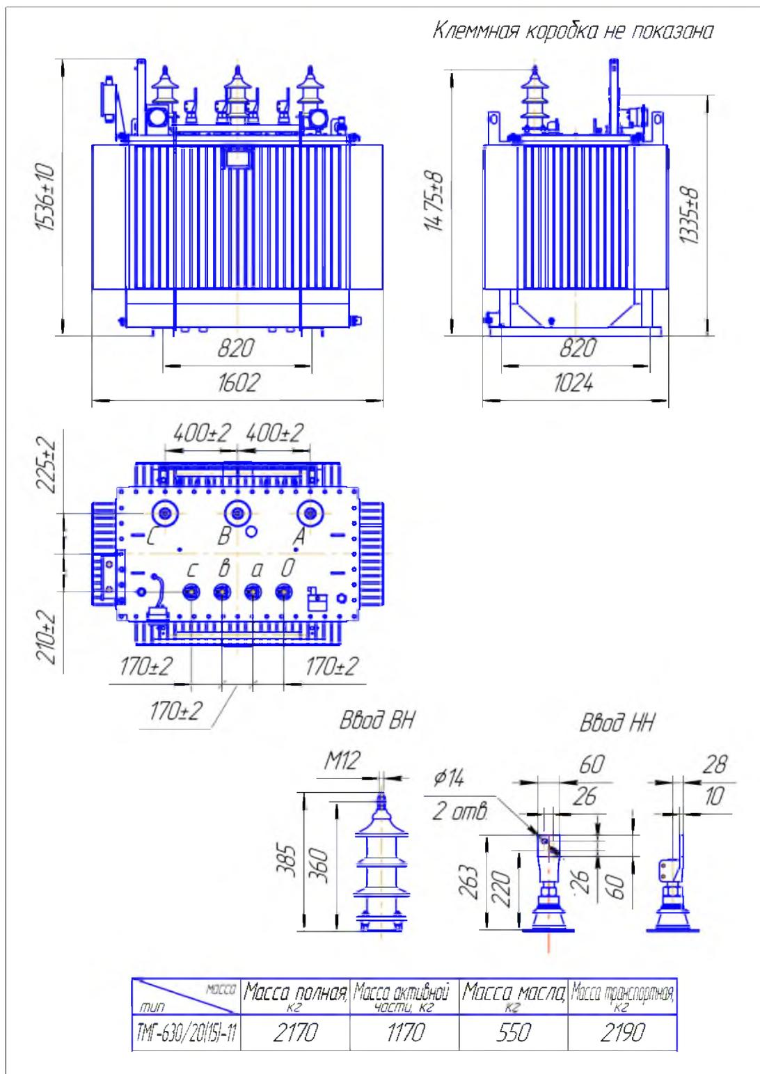
Рис. 2.5 Габаритные, установочные и присоединительные размеры трансформатора ТМГ - 630/20-11
