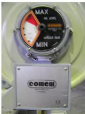
Рис. 7.2 Маслоуказатель стрелочного типа **LA14**
