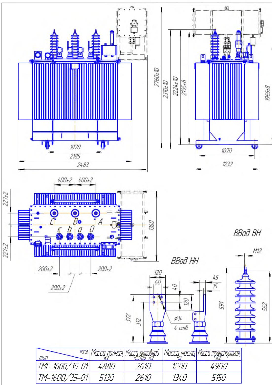
Рис. 3.7 Габаритные, установочные и присоединительные размеры трансформатора ТМ(Г) - 1600/35-01
