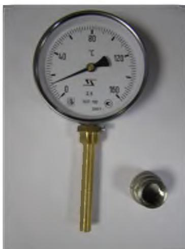
Рис. 7.3 Термометр стрелочный типа **ТБП-63**
