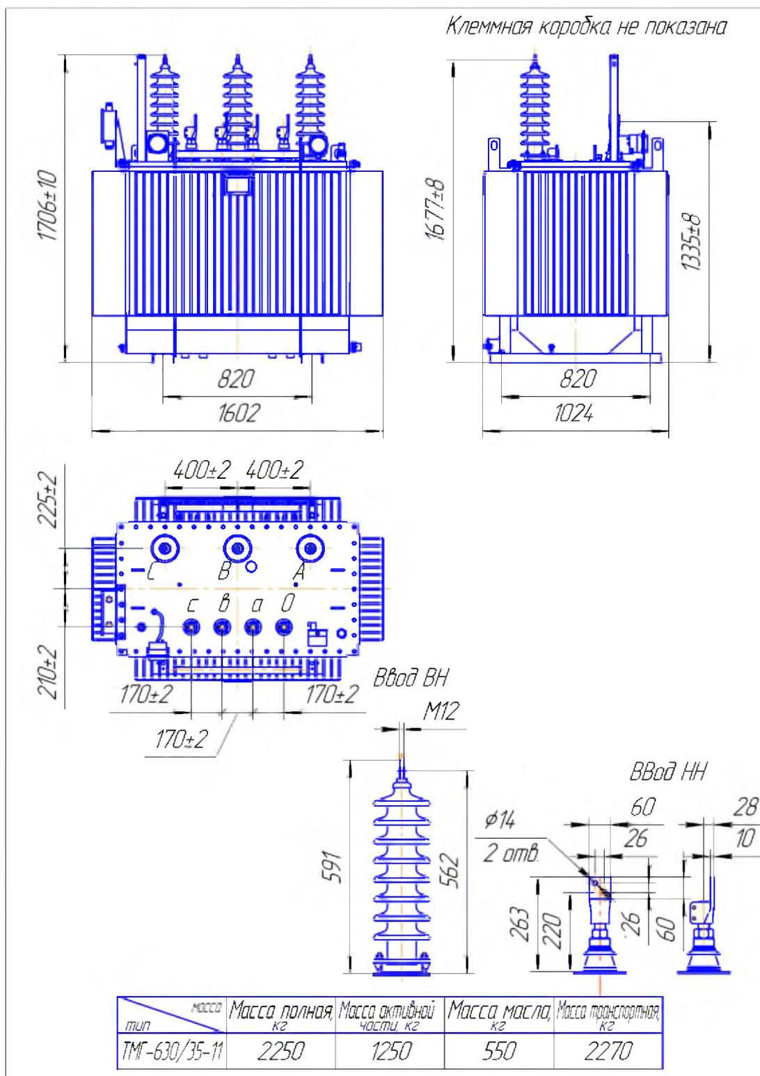
Рис. 3.5 Габаритные, установочные и присоединительные размеры трансформатора ТМГ - 630/35-11
