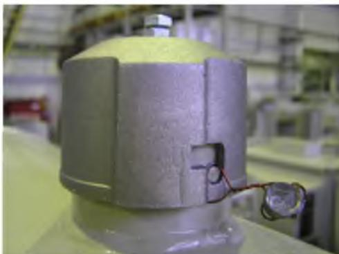
Рис. 7.6 Клапан сброса давления **5CO**
