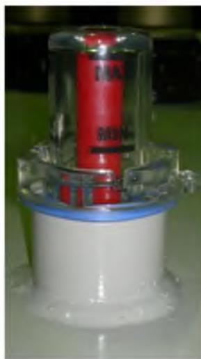
Рис. 7.1 Маслоуказатель поплавкового типа СН-45
