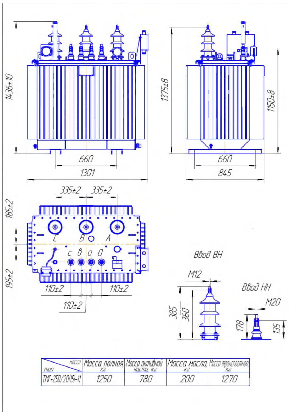
Рис. 2.3 Габаритные, установочные и присоединительные размеры трансформатора ТМГ - 250/20-11
