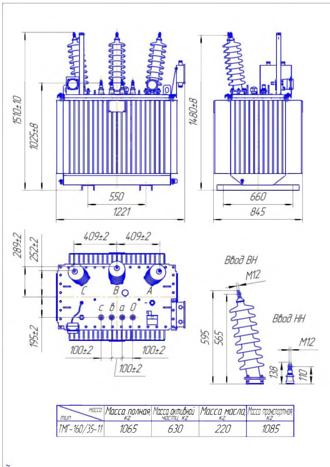
Рис. 3.2 Габаритные, установочные и присоединительные размеры трансформатора ТМГ - 160/35-11
