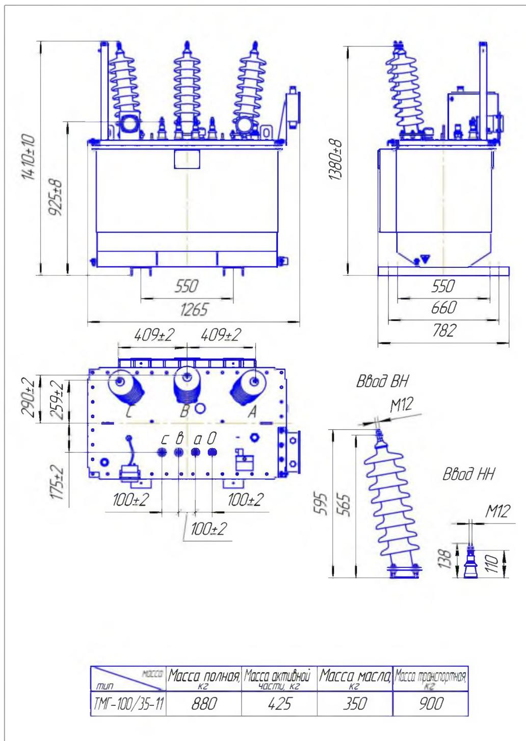
Рис. 3.1 Габаритные, установочные и присоединительные размеры трансформатора ТМГ - 100/35-11
