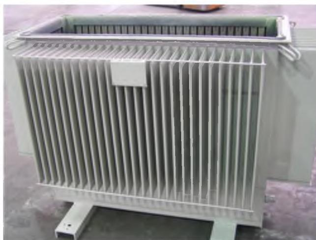
Рис. 2.5 Корпус бака трансформатора
