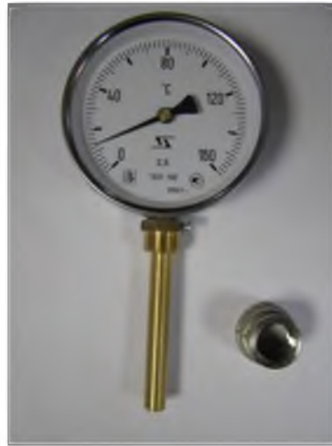
Рис. 7.4 Термометр стрелочный типа ТБП-63
