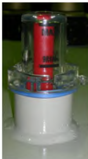
Рис. 7.1 Маслоуказатель поплавкового типа СН-45
