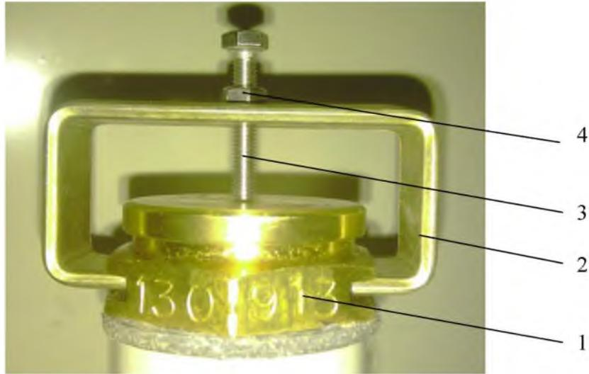
Рис. 8.2 Клапан сброса давления с транспортировочной скобой
