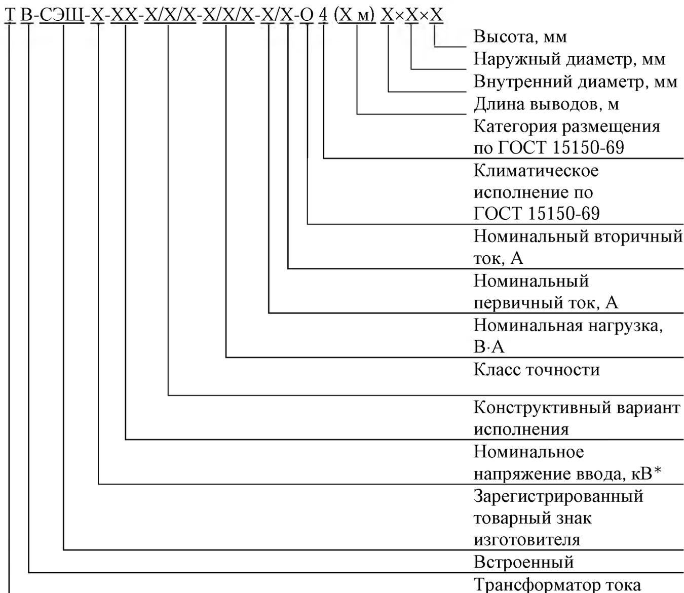
\* - Номинальное напряжение ввода является величиной условной. При обеспечении заданных характеристик и посадочных размеров трансформаторы могут устанавливаться на вводах любого класса напряжения. Вводы силового электрооборудования являются первичными обмотками трансформаторов.
