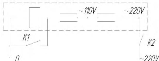
В качестве контакта К1 используется контакт главной цепи одной из фаз выключателя нагрузки. В качестве контакта К2 может быть использован контакт путевого выключателя ВП-19 или любого другого механического или герконового путевого или концевого выключателя.
