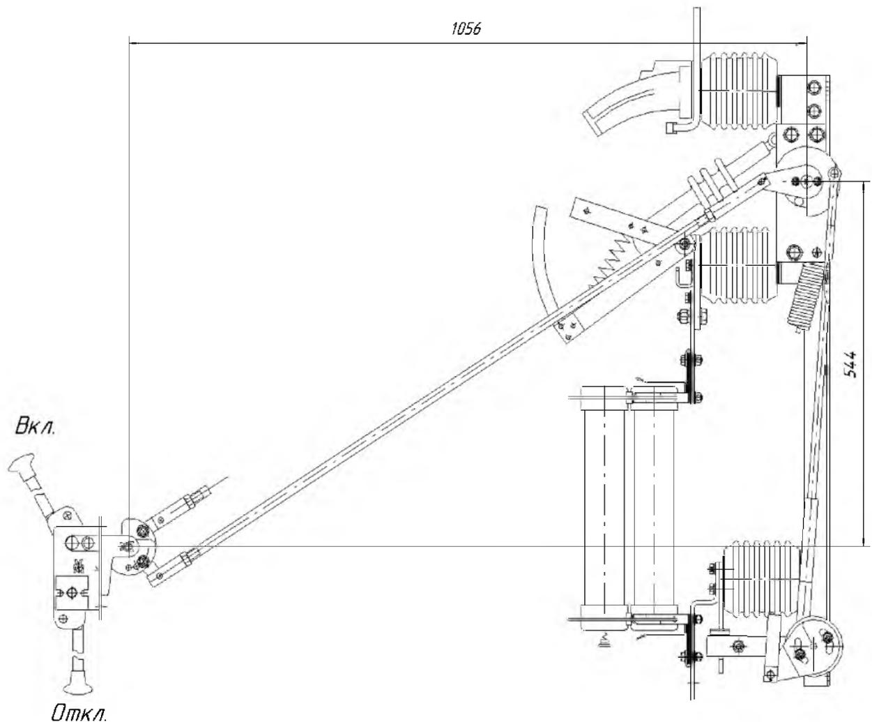
Рисунок 4а – Нижнее расположение привода относительно вала ВНА
