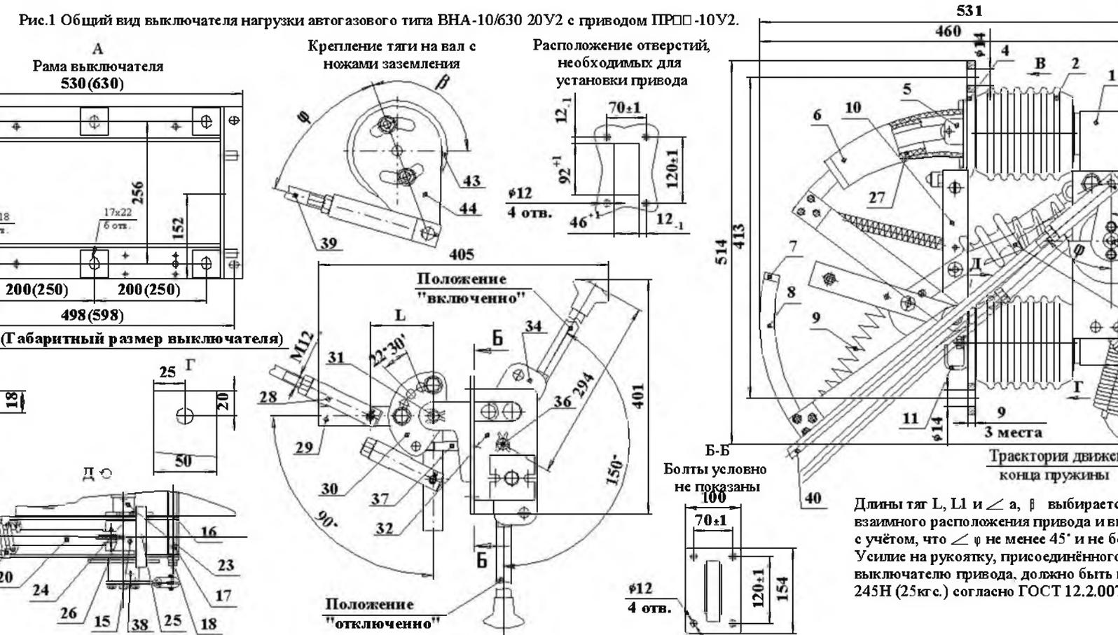
3.4 Движение к подвижным контактам 10 передается через рычаг 13, изготовленный из пресс-материала. Рычаг шарнирно соединен с главными подвижными контактами 10 и главным валом выключателя через втулку с резьбой. Поворотом рычага 13 во втулке регулируется глубина вхождения главных подвижных контактов в неподвижные. Главные подвижные контакты 10 соединены с дугогасительными контактами 8 с помощью пружины 9, которая обеспечивает включение дугогасительных контактов 8.
