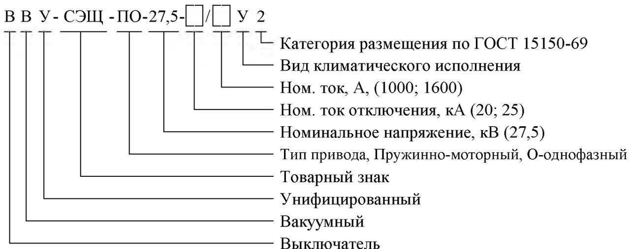
Пример записи условного обозначения выключателя с пружинно-моторным приводом, на напряжение 27,5 кВ, номинальный ток 1000 А, номинальный ток отключения 20 кА при заказе и в технической документации: ВВУ-СЭЦ-ПО-27,5-20/1000У2.
