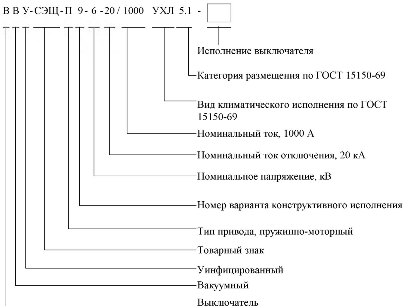
Пример записи условного обозначения выключателя вакуумного унифицированного в технической документации при заказе с пружинно-моторным приводом, исполнения 9, на напряжение 6 кВ, номинальный ток отключения 20 кА и номинальный ток 1000 А, климатического исполнения УХЛ и категории размещения 5.1, исполнения 01:
